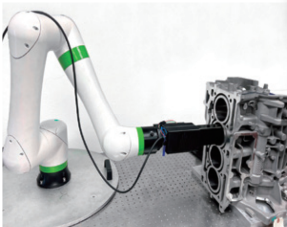
・ロボットアームを使った測定イメージ
