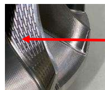
サメ肌模擬形状 凸長手：3.3, 凸短手： 1.0mm 高さ：0.1mm
