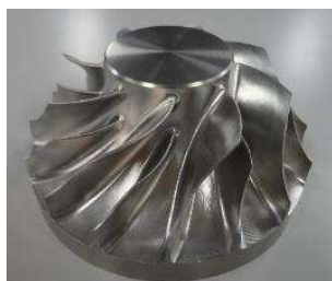
インペラーサンプル サイズ：φ100 L50mm 材質：SUS303 先端羽厚み：0.8mm
