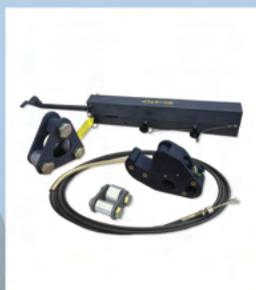
抽出力変換連結器(EFTC)は、すべての空中投下器材において最も重要な装置の一つです。搭載物料が抽出されると、EFTCは抽出傘の引張力を主傘の開傘力に変換します。
