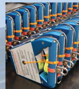
弊社の特許製品である緊急降下装置(EDD)は、多くのワイドボディ旅客機及び軍用輸送機に標準装備されています。
