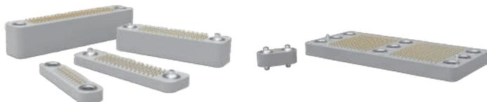
Z シリーズは半田レスの高密度基板間接続用コネクタです。接触式コンタクトのため、取外しが容易に可能です。
