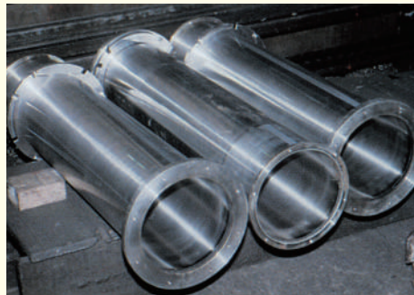
超伝導用部品 肉厚1.6t(胴部) 材質：SUS310S
