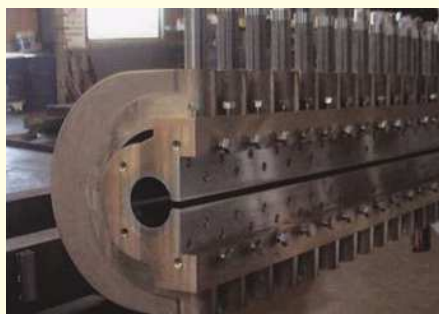
5460Lホッパー 5/100交差で差込み 材質：銅合金、SUS304
