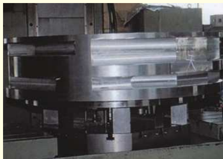
ハワイ・マウナケア山設置 望遠鏡「すばる」の副鏡加工 材質：鉄、鍛造品
