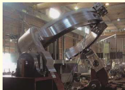
医療機械 組立試験 材質：AC4C
