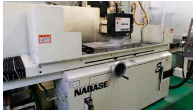
平面研削の加工写真 アリ溝加工も対応します
