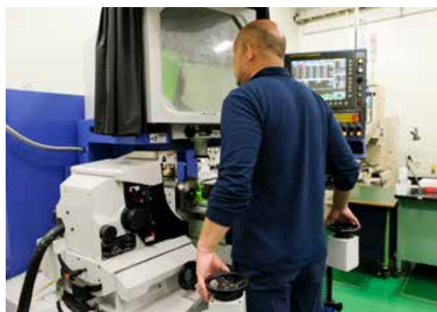
投影機で 20 倍 or 50 倍に拡大して加工 複雑かつ微細加工の精度を追究します
