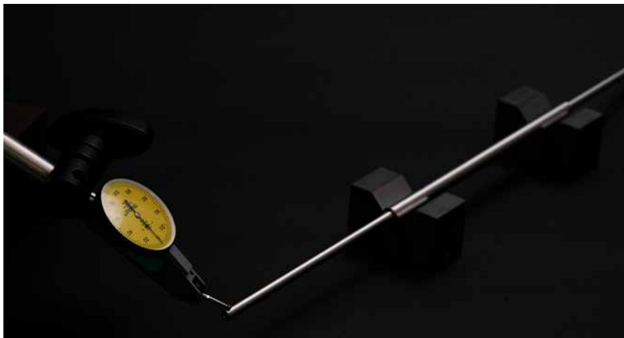
長細物の振れ確認作業。φ 5mm×400mm のインコネル材を自社加工にて振れ幅 0.002mm を追求
