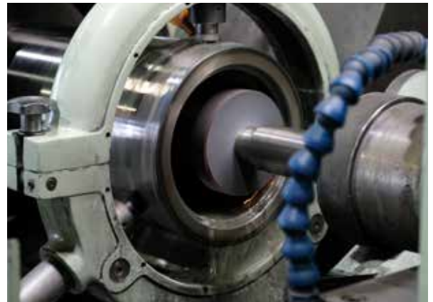
長尺の加工もフレ止めを使用し 0.002mm 以下の精度を実現
