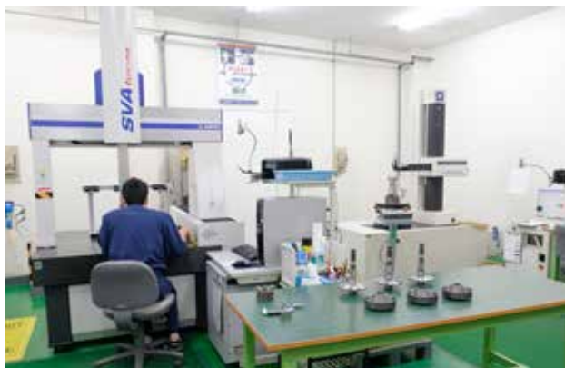
高精度測定機による精度保証体制 24 時間 20℃に保たれた恒温室
