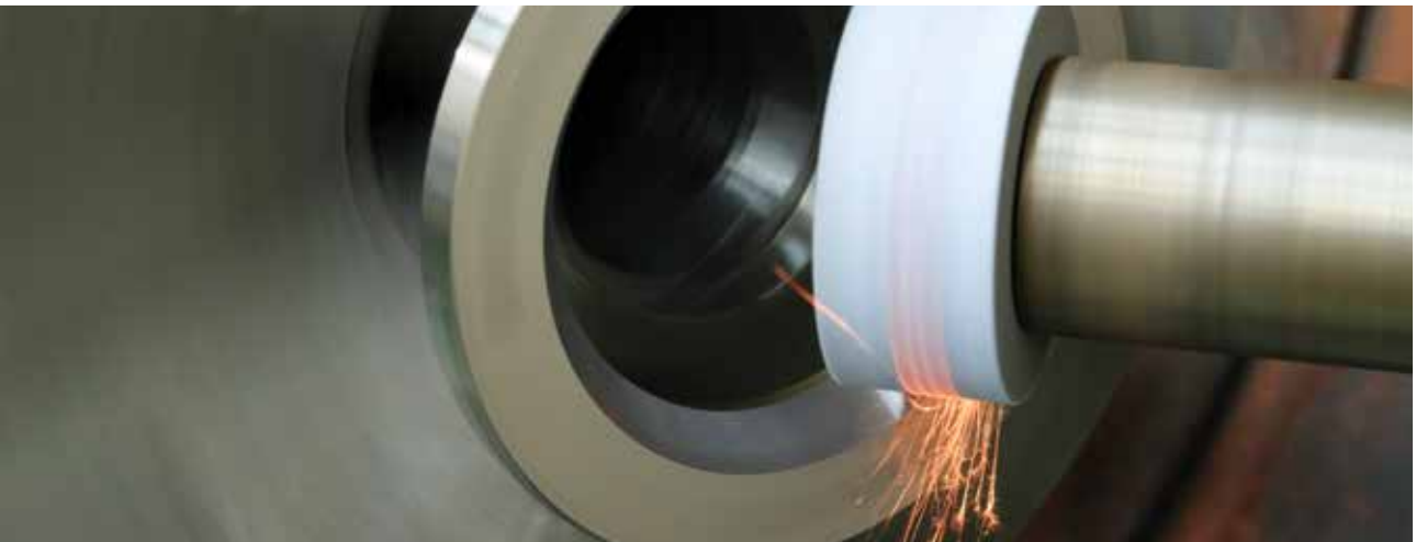
大径φ 70 70°のテーパ加工。大物φ 200以上の加工実績も有り
