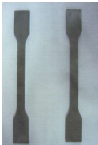
PP材抗菌マスターバッチ+PA材 耐久試験用ダンベル試験片
