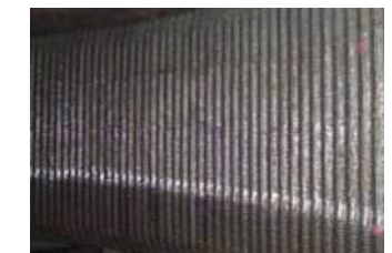
熱交換用チューブにインコネル合金を肉盛溶接
