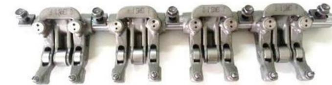
鍛造品ロッカームの切削/浸炭焼入れ(外注)/研削/ランク分け組立シャフトの**高周波焼入れ**等(月産 18k台)
