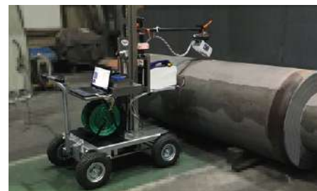
ロールの加工、熱処理の応力確認
