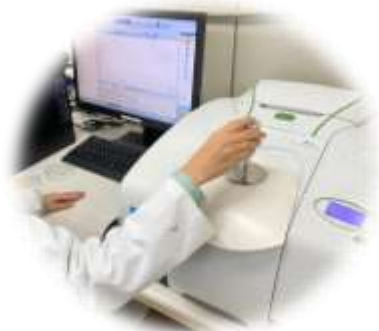
フーリエ変換赤外線分光分析装置 FT-IR+ATR (Perkin Elmer) 有機物成分分析
